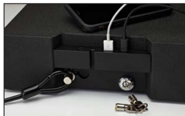
Porty USB-A a USB-C, záložní klíč a bezpečnostní kabel.
