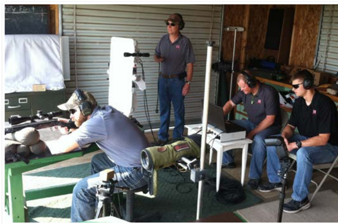
Inženýři Hornady používají Dopplerův radar, aby zjišťovali účinky aerodynamického zahřívání a potvrdili účinnost hrotu Heat Shield®.
