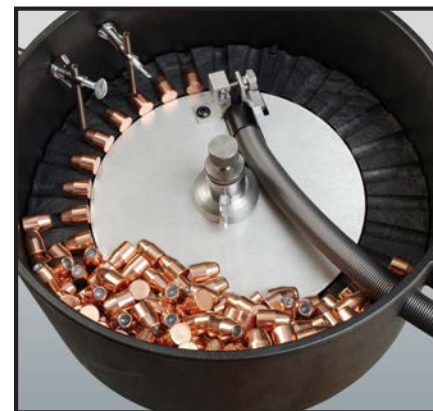
Podavač střel do pistolí nefunguje s olověnými nebo pokovenými střelami.
